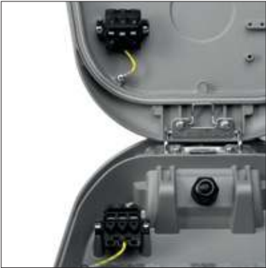
Completo di sezionatore di linea in doppio isolamento che interrompe l'alimentazione elettrica all'apertura della copertura. Complete with line disconnecter in double insulation that interrupts the power supply when the cover is opened.
