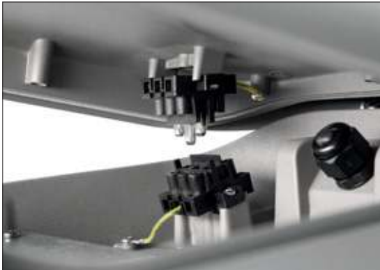
Completo di sezionatore di linea in doppio isolamento che interrompe l'alimentazione elettrica all'apertura della copertura. Complete with line disconnecter in double insulation that interrupts the power supply when the cover is opened.
