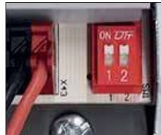
Dip-Schalter zur Auswahl des Ausgangsstroms
