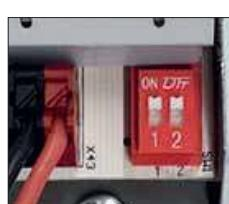
Dip-Schalter zur Auswahl des Ausgangstroms
