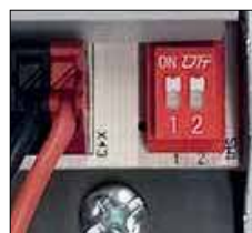
Dip-Schalter zur Auswahl des Ausgangsstroms Commutateur dip pour la sélection du courant de sortie
