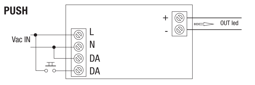
Fig. 3 - Beispiel einer pulsierenden Steuerungsanwendung - Exemple d'application de contrôle pulsé
